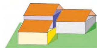
Organisation semblable au schéma précédent, mais avec un terrain en pente. Pour éviter de trop terrasser le terrain, des demi-niveaux peuvent être créés entre chaque partie de la maison.
