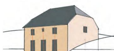
Borée, ouverture agrandie avec un linteau métallique droit qui permet la pose aisée d'une menuiserie vitrée. L'ancien cintre sert d'arc de décharge.
