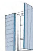
Le volet à lames possède une double épaisseur de bois qui le rend plus isolant.
