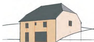
Saint-Martial, agrandissement d'ouvertures avec un linteau métallique. Paradoxalement, ce type de linteau est cohérent dans l'organisation de la façade.
